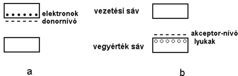
2. ábra. a: n-típusú, b: p-típusú félvezető sáv szerkezete
